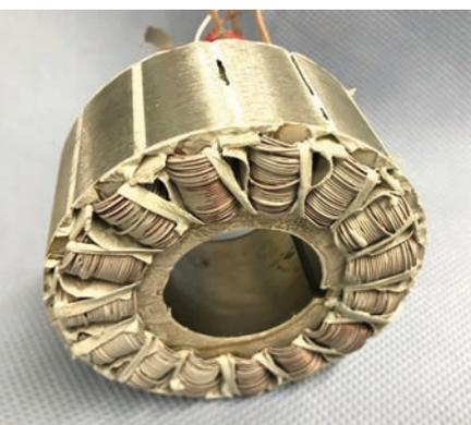
*Polymerkeramisch isolierter Stator einer Außenläufermaschine.*
